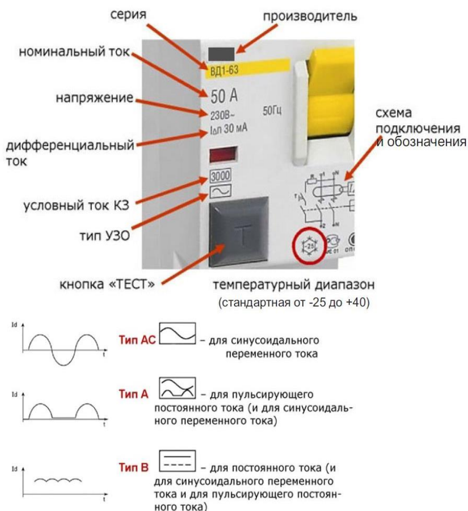
Рисунок 5. Маркировка УДТ
