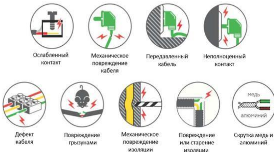
Рисунок 6. Возможные причины искрения в электропроводке
